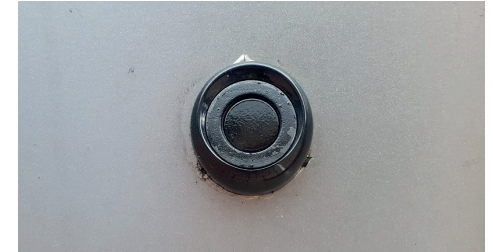
Montaje de un conjunto formado por un sensor y un casquillo en una superficie vertical.
